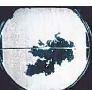
レーザシート法による試験用火花点火機内火炎の断面画像（燃焼初期の様子、黒い部分が燃焼ガス、白い部分が未燃焼ガス）
