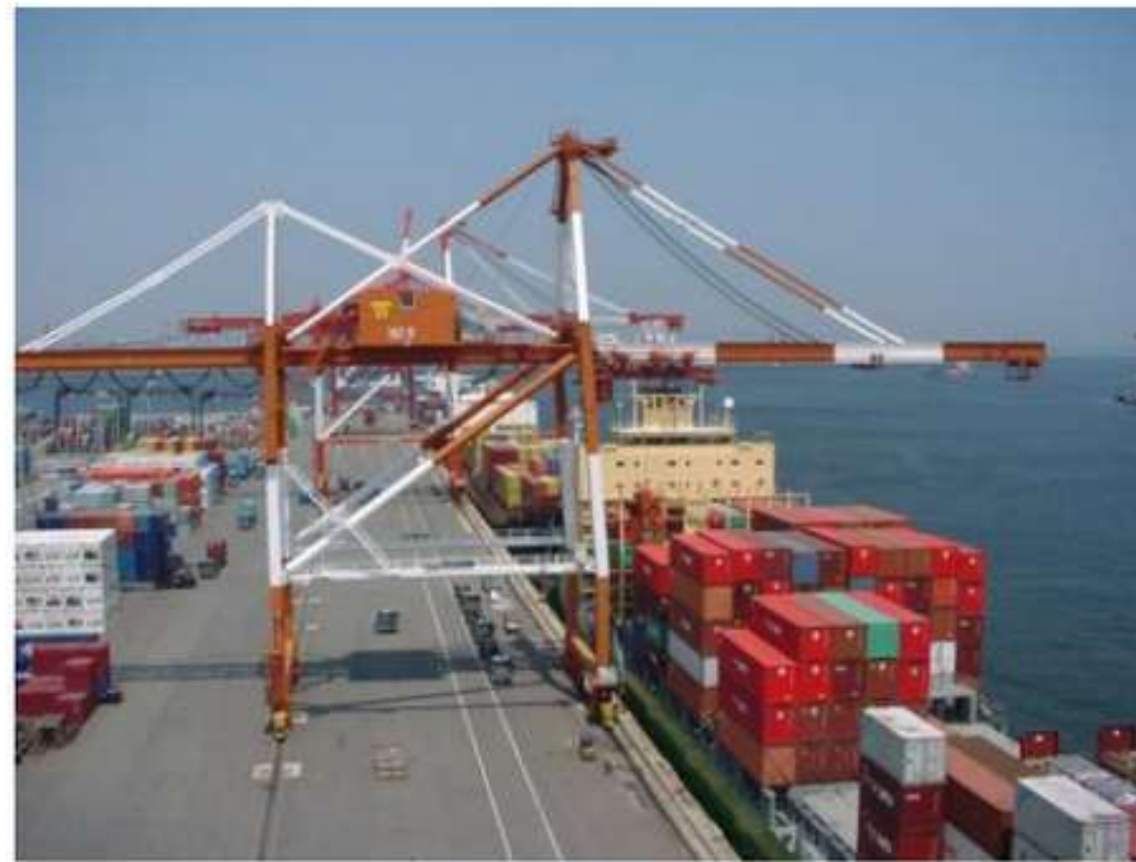
神戸港(PC-18)におけるガントリークレーンによる 海上輸送コンテナ船積み作業
