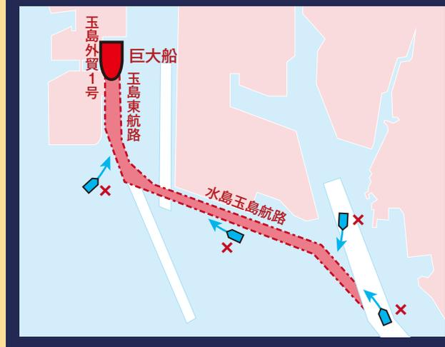
水島玉島航路及び玉島東航路を運航する船舶及び航路外より入航・横切りしようとする船舶は、行き会いまたは巨大船の直前の航行とならないよう「水島港運航調整ガイドライン」を確認の上、安全航行をお願いします。
