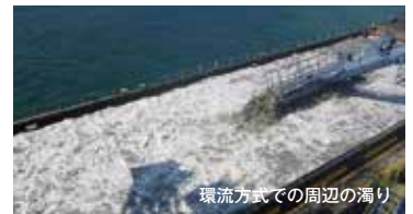
図-2 環流式バジローディング方式ポンプ浚渫船
