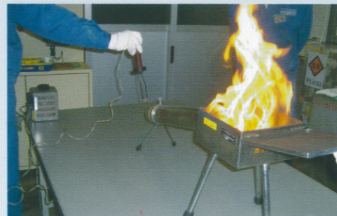
「爆燃」の蒸発箱実験
