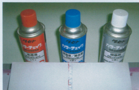
「寿命予測」の浸透探傷試験
