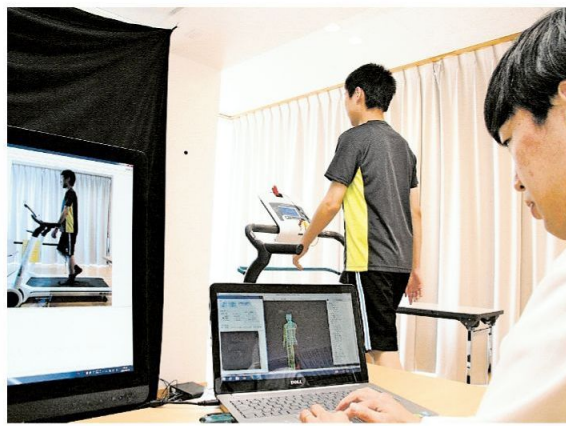
ダイヤ工業が導入した動作解析装置。個々の体形に合わせた全身サポーターを設計できる
