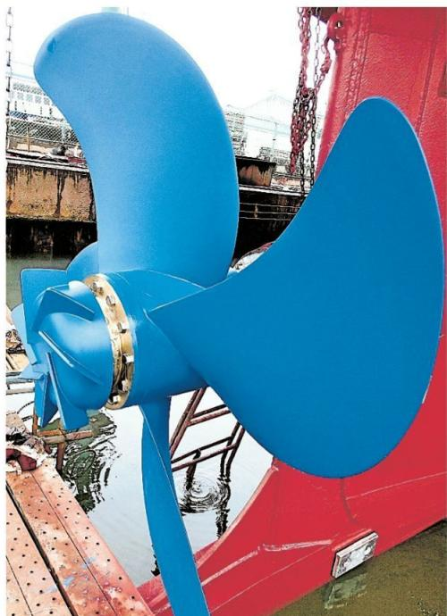
初めて正規販売したCFRP製スクリュー。左端はフィン付きのプロペラキャップ
