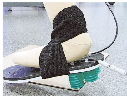
装置の足底部分。緑色のポンプで人工筋肉に空気を送る
