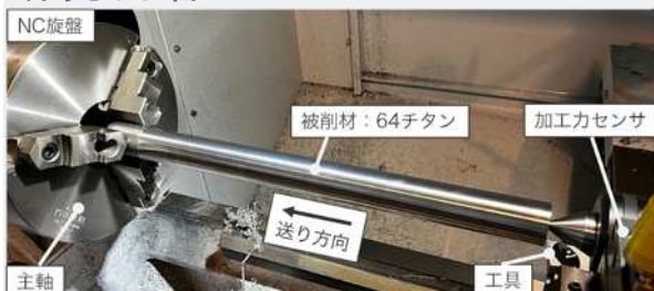
図1 加工力センサを設置したNC旋盤での実験の様子
