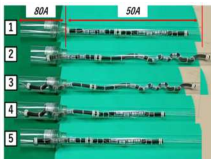
図5 異径配管の走破実験風景
