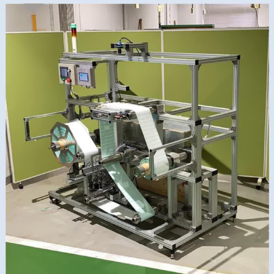
図1.ラベル欠品検査装置
