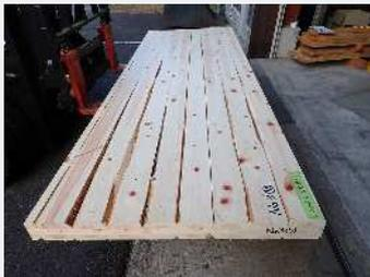
製造した土木用CLT（幅：1m、厚み：9cm、長さ：約2.9m）
