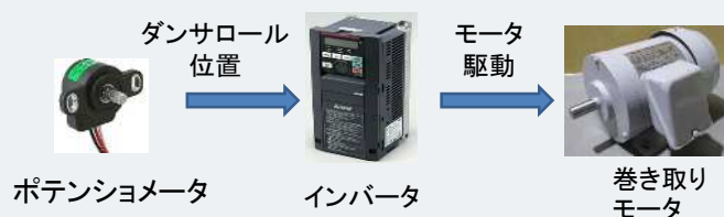
ダンサ制御による巻き取り
