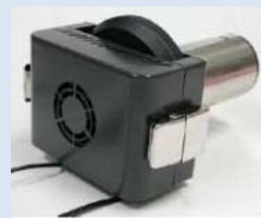
恒温槽のケーブル孔に差し込み 内部を撮影するカメラ
