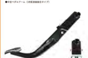
従来アーム部は1枚の厚板構造としていましたが、薄板1枚板または薄板2枚板の閉断面構造とすることで強度を保ちつつ、軽量化とコスト低減を達成した技術です。お客様のご要求に応じた最適仕様をご提案いたします。
